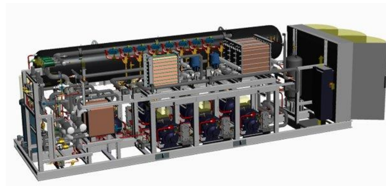
跨临界CO2机组
