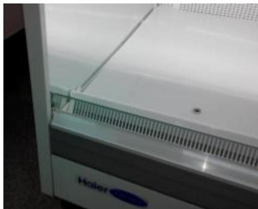
回风格栅厚度1.2mm (提升强度), 回风钢化玻璃厚度8 mm (改善制冷效果)
