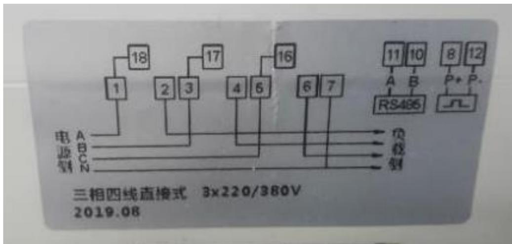
A相线进，接线端子1；A相线出，接线端子2；
